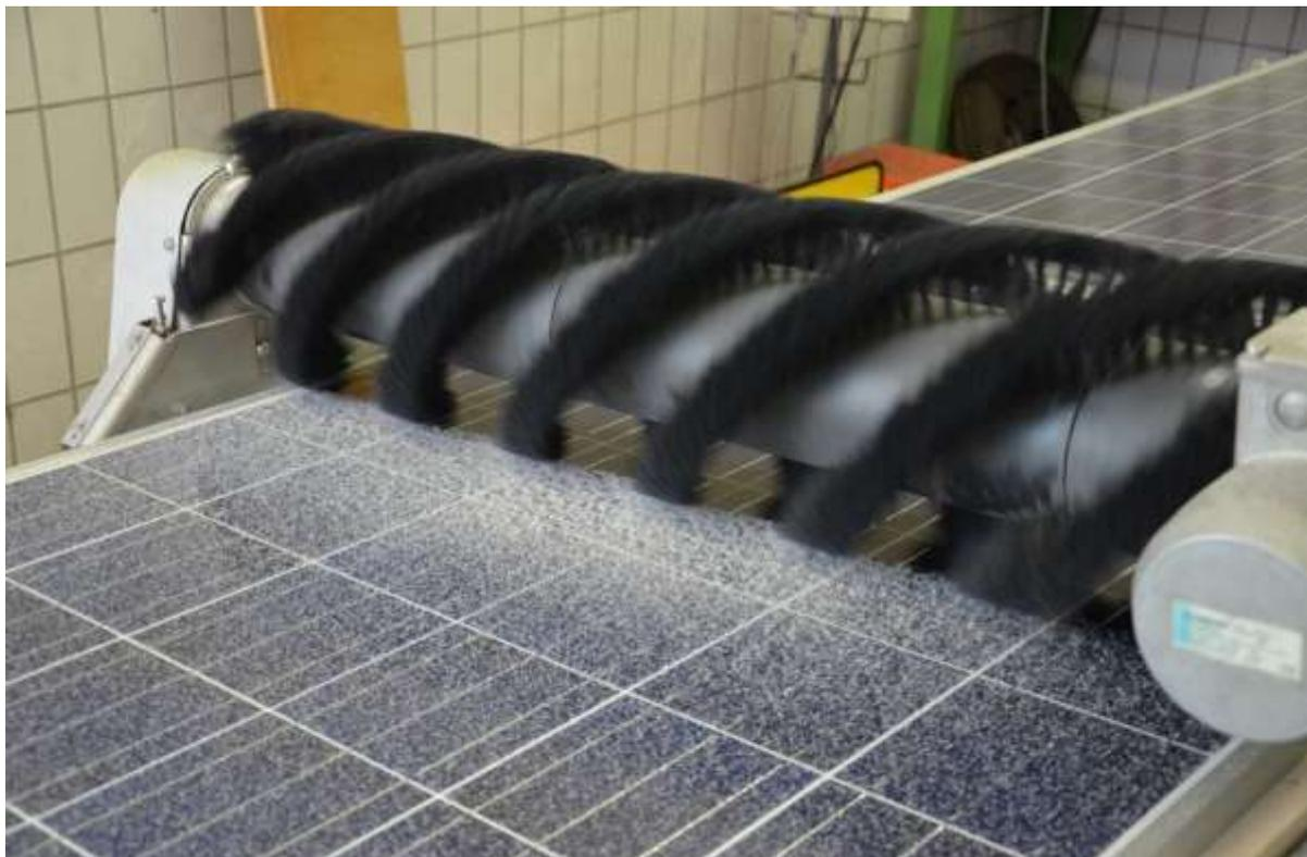
Abbildung 2: Trockenreinigung mit der SunBrush mobil Reinigungsanlage beim Durchlaufen der 1002 Reinigungsdurchgänge. Dies entspricht einer Reinigung pro Woche über einen Zeitraum von 20 Jahren.
