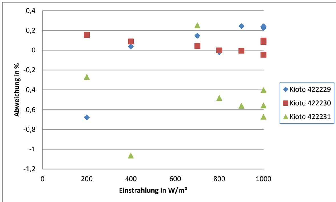
Abbildung 4: Ergebnisse der Leistungsmessungen der drei Testmodule vor und nach den 1002 Durchläufen bei unterschiedlichen Einstrahlungen. Während zwei Module eine Leistungssteigerung von etwa 0,1% zeigen ist bei dem Dritten Modul eine Leistungsänderung von etwa -0,5% sichtbar.
