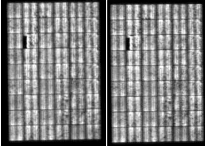
Abbildung 3: Aufnahme Solarmodul Kioto Solar Seriennr. : 422229 vor (links) und nach (rechts) dem Test mit der EL-Kamera
