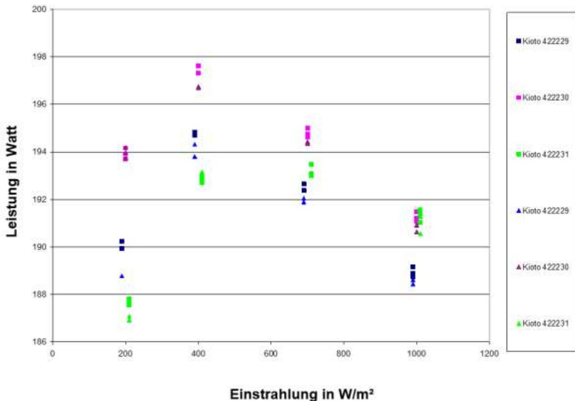
Abbildung 1: Ergebnisse der Leistungsmessung bei unterschiedlichen Einstrahlungen vor und nach den 4338 Reinigungszyklen.
